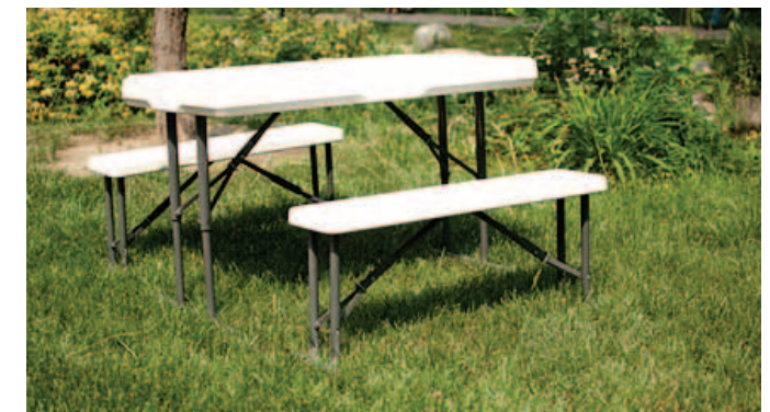
Tampo confeccionado em Polipropileno, estrutura dobrável em aço. Pintura com tinta em pó pelo sistema eletrostático na cor a definir. Com tratamento anti-corrosivo à base de fosfato de zinco refinado.
